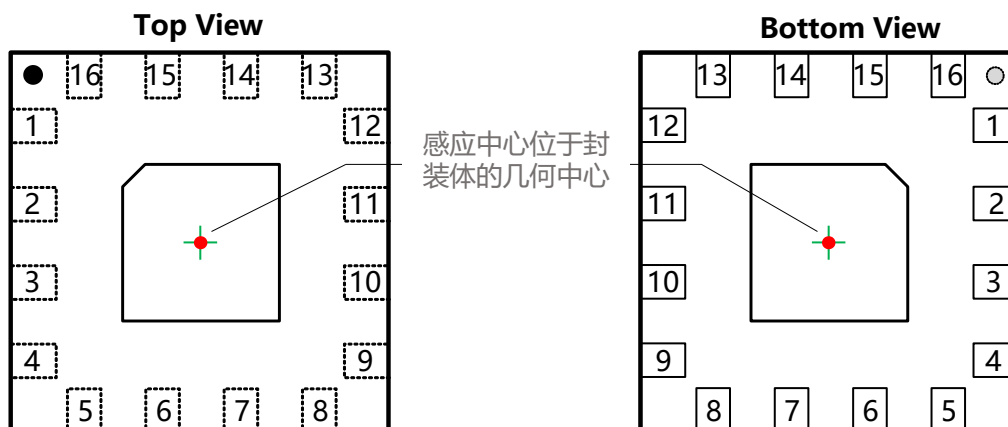
图-2: QFN-16 封装外观图
